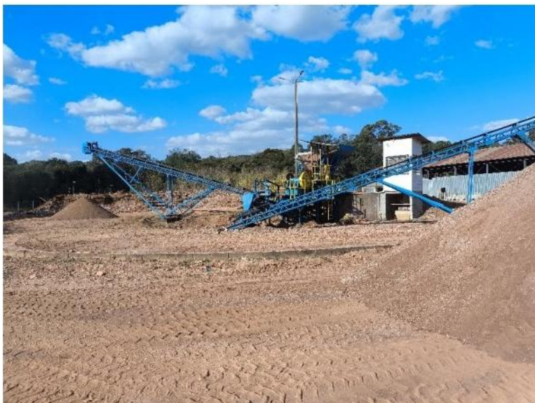
Figura 2 - Máquina de moagem e separação dos resíduos.
